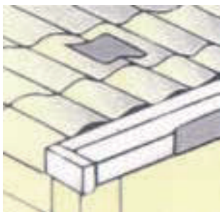
雨漏りの補修
